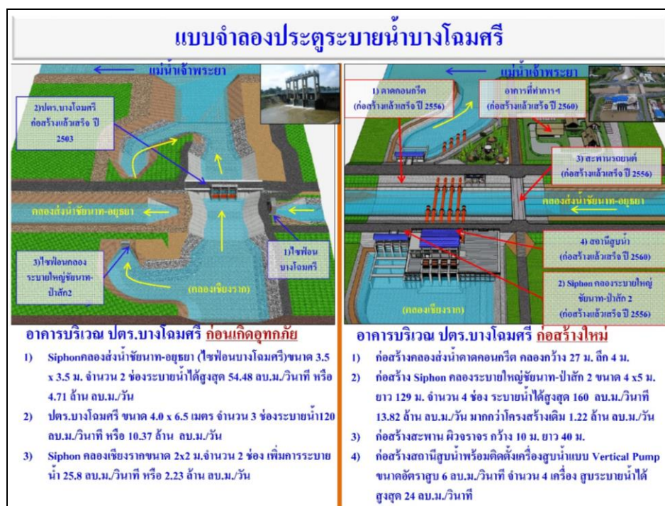
แบบจำลองแสดงโครงการเพิ่มประสิทธิภาพการบริหารจัดการน้ำบริเวณประตูระบายน้ำบางโฉมศรี (เปรียบเทียบอาคารเดิมก่อนเกิดอุทกภัยกับอาคารที่ก่อสร้างใหม่)
